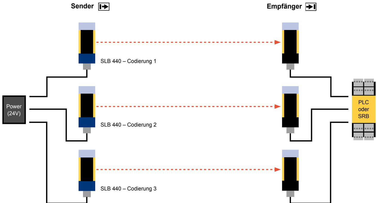
Keine optische Beeinflussung der Systeme bei Verwendung mehrerer Lichtschranken durch 4-fach Codierungsstufe
