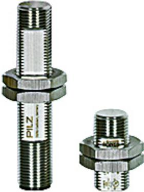
Sicherheitssensor zur Stellungsüberwachung beweglicher Schutzeinrichtungen nach EN 60947-5-3, 2 n/o, 1 Hilfskontakt n/o, 8-pol. M12 Stiftstecker, für Anwendungen bis SIL 3/PL e/Kat. 4, zylindrische Bauform M12, IP69, VP = 1 Sensor mit M12 Betätiger, Schaltabstand 8 mm, für Anwendungen mit PSEN ix1, Edelstahl Gehäuse.
