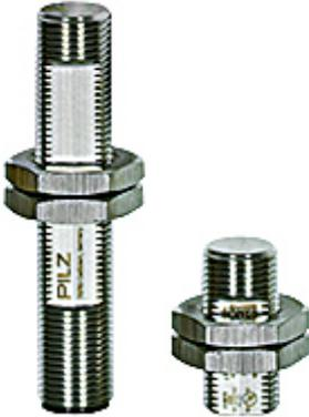
Sicherheitssensor zur Stellungsüberwachung beweglicher Schutzeinrichtungen nach EN 60947-5-3, 2 n/o, 1 Hilfskontakt n/o, 8-pol. M12 Stiftstecker, für Anwendungen bis SIL 3/PL e/Kat. 4, zylindrische Bauform M12, IP69, VP = 1 Sensor mit M12 Betätiger, Schaltabstand 8 mm, Edelstahl Gehäuse.
