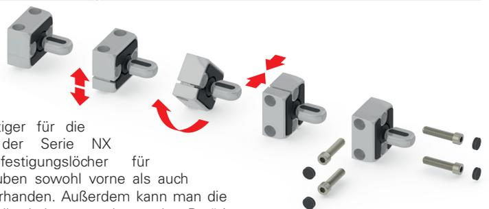
Am Betätiger für die Schalter der Serie NX sind Befestigungslöcher für M5-Schrauben sowohl vorne als auch seitlich vorhanden. Außerdem kann man die beiden Halbschalen, aus denen das Betätigergehäuse besteht, öffnen und den Bolzen drehen, so dass man die Arbeitsebene des Betätigers um 90° drehen kann.
