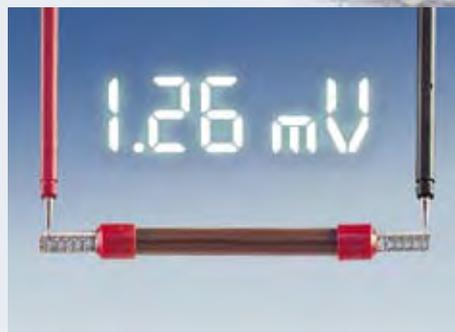
Der Spannungsfall darf vor und nach der Prüfung 3,2 mV und das 1,5-fache des zum Prüfbeginn gemessenen Wertes nicht überschreiten.
