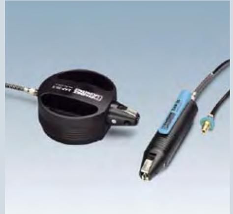
Die ZAP-Presszangen sind druckluftbetriebene Werkzeuge für Aderendhülsen im Querschnittsbereich 0,25 bis 10 mm<sup>2</sup>. Die Auslösung des Pressvorganges erfolgt variantenabhängig über ein Fußventil oder Handauslöser. Für den schnellen Zugriff auf die Aderendhülsen sorgen zwei integrierte Aufnahmebehälter.
