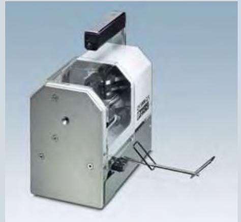
Der Abisolier- und Crimpautomat CF 3000-2,5 verarbeitet Aderendhülsen in Bandwarenausführung mit Isolierkragen nach DIN 46228-4. Das Gerät kann Leiter in einem Arbeitsgang abisolieren und mit Aderendhülsen versehen. Die Umrüstung des Automaten auf unterschiedliche Querschnitte ist innerhalb einer Minute möglich.
