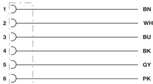
Kontaktbelegung der M8-Buchse
