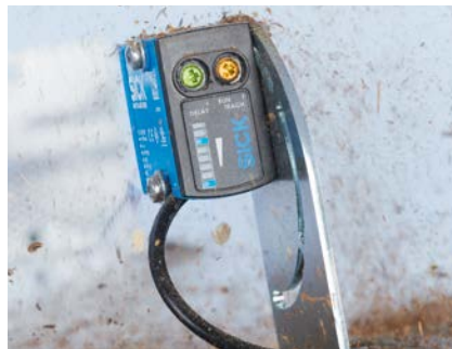
BluePilot: Je geringer der Abstand der blauen LEDs zueinander ist, desto höher ist der Verschmutzungsgrad (am Beispiel RAY10)
