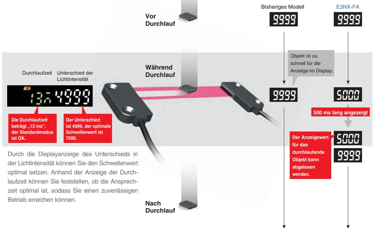
Durch die Displayanzeige des Unterschieds in der Lichtintensität können Sie den Schwellwert optimal setzen. Anhand der Anzeige der Durchlaufzeit können Sie feststellen, ob die Ansprechzeit optimal ist, sodass Sie einen zuverlässigen Betrieb erreichen können.
