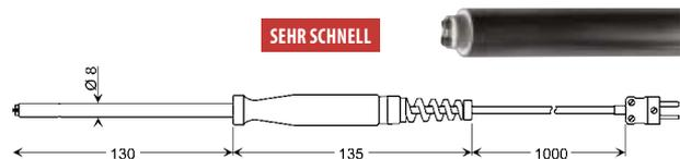
2 laserverschweißte federnde Spiralfedern aus NiCr-Ni,
