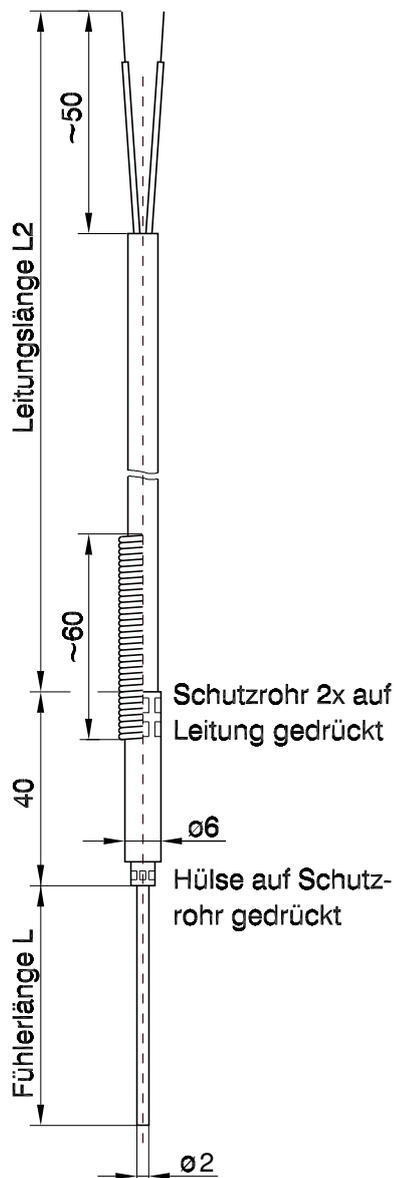
Mantelthermoelement mit Anschlusschülse und Ausgleichs- oder Thermoleitung
