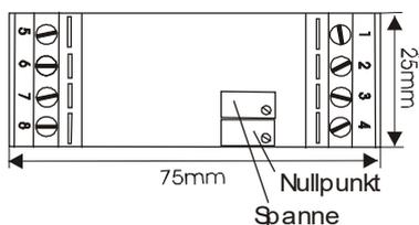
Zum Öffnen der Klarsichthaube muss diese vorsichtig an den schmalen Seiten nach innen gedrückt und abgezogen werden. Die Lage der Regler ist aus dem Bild ersichtlich. Die Regler sind gegen versehentliches Verstellen gesichert. Für geringe Korrekturen kann der Zero-Regler verstellt werden. Der Spanne-Regler sollte möglichst nicht verstellt werden.
