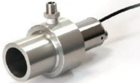
Sensoraufsatz für die Verwendung in sehr heißen und rauen Umgebungen. Druckluftanschluss für Luftkühlung und Linsenreinigung. ArtNr. 07AC
