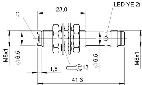
1) Optische Achse, 2) Ausgangsfunktion
