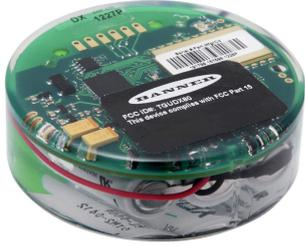
Der M-GAGE-Sensor verwendet eine passive Sensortechnologie zur Erfassung großer Eisenobjekte. Der Sensor misst die Änderung im natürlichen Magnetfeld der Erde (dem Umgebungsmagnetfeld), die durch die Anwesenheit eines ferromagnetischen Objektes hervorgerufen wird.
