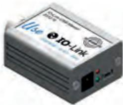
Mit dem IO-Link-Master ist die einfache Parametrierung von IO-Link-fähigen Sensoren möglich. Die passende Konfigurationssoftware ist als Download auf [www.iq2-development.com](http://www.iq2-development.com) verfügbar und kann auf einem PC oder Notebook installiert werden. Das Set enthält neben dem Master und einem Netzteil auch ein M12-Verbindungskabel zum Sensor und ein USB-Kabel für den Anschluss an den PC.
