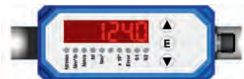
Die Parametrierung der Sensoren erfolgt über die IO-Link-Schnittstelle oder die frontseitigen Taster. Im 6-stelligen Display werden die Messwerte angezeigt und können als Prozessdaten über die IO-Link-Verbindung an eine SPS gesendet werden. Im SIO-Modus stehen dem Anwender die konfigurierten Analog- und Schaltausgänge zur Verfügung.
