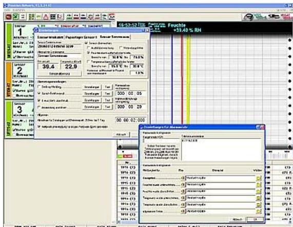
Hier können die Grenzwertüberwachung und Alarmfunktionen für jedes Sensorgerät individuell eingestellt werden.
