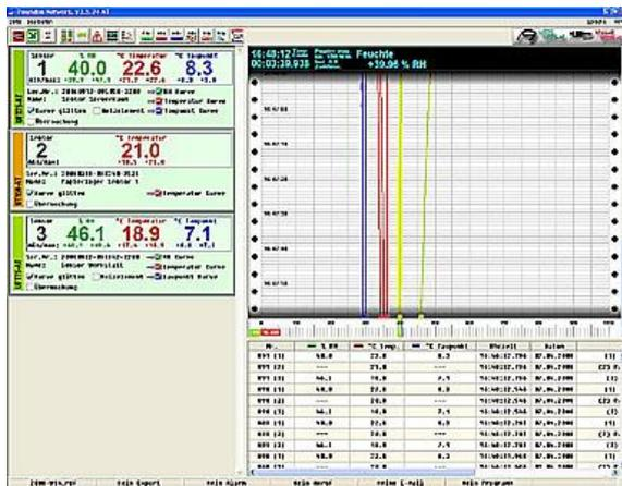
Die Poseidon Network Startseite zeigt die aktuellen Messwerte von angeschlossenen Sensoren. Das Programm erkennt automatisch, wenn ein neues Sensorgerät eingesteckt oder eines entfernt wird. Es können so viele Sensoren eingesetzt werden wie vom PC-System verwaltet werden.
