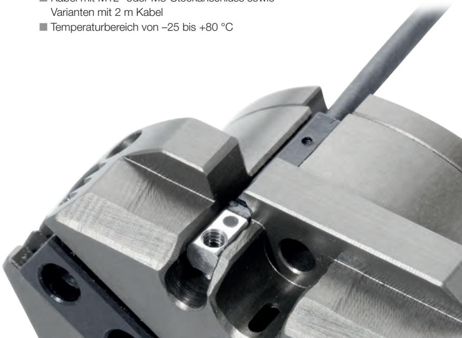
Der magnetische Sensor BMF 203 an einem zentrischen Greifer.
