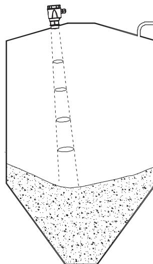
Ausrichtung der Antenne auf das Konusende erlaubt Messung bis zum Behälterboden
