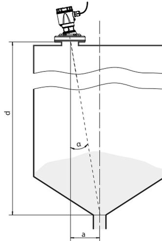
Abb. 17: Vorschlag für den Einbau nach Ausrichtung NivoRadar 7200
