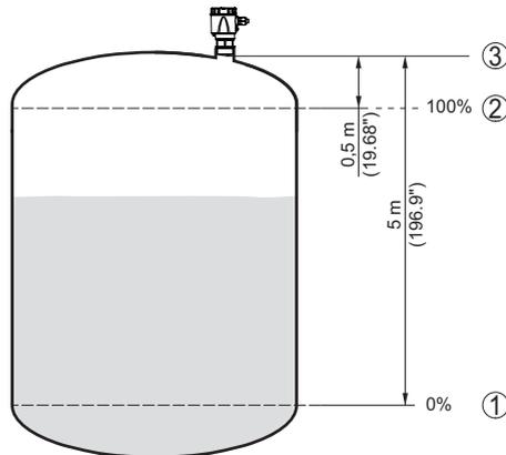
Abb. 24: Parametrierbeispiel Min./Max.-Abgleich
