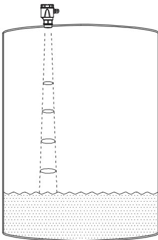
Senkrechter Einbau ohne Ausrichtung der Antenne
