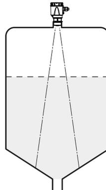
Abb. 10: Montage des Radarsensors an Behältern mit konischem Boden
