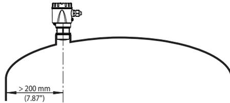
Abb. 9: Montage des Radarsensors an runden Behälterdecken
