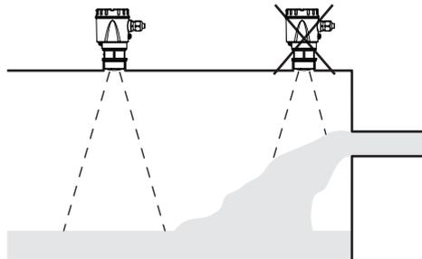
Abb. 11: Montage des Radarsensors bei einströmendem Medium
