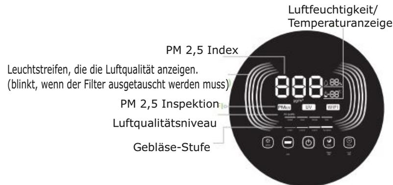
**Starttaste:** Wenn der Luftreiniger eingeschaltet ist, wird die Temperatur angezeigt. Die Starttaste wird rot und wechselt in den Standby-Modus.
