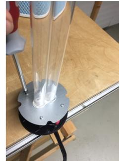
Entfernen Sie die 4 Schrauben vom Abdeckblech und das Abdeckblech.
