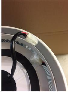
Trennen Sie das UVC-Lampenkabel mit dem Verbindungsstecker, und entfernen Sie den HEPA- und Kohlefilter.
