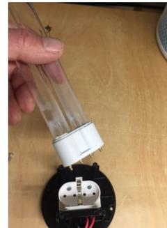
Setzen Sie die neue UVC-Lampe wieder in die Lampenfassung und montieren Sie das Abdeckblech mit den 4 Schrauben.
