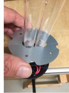
Nehmen Sie den Lampensockel aus dem HEPA-Filter.
