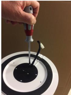
Bitte entfernen Sie die UVC-Lampe, durch lösen der 4 Sockelschrauben vom Filtergehäuse, bevor Sie den Filter austauschen.
