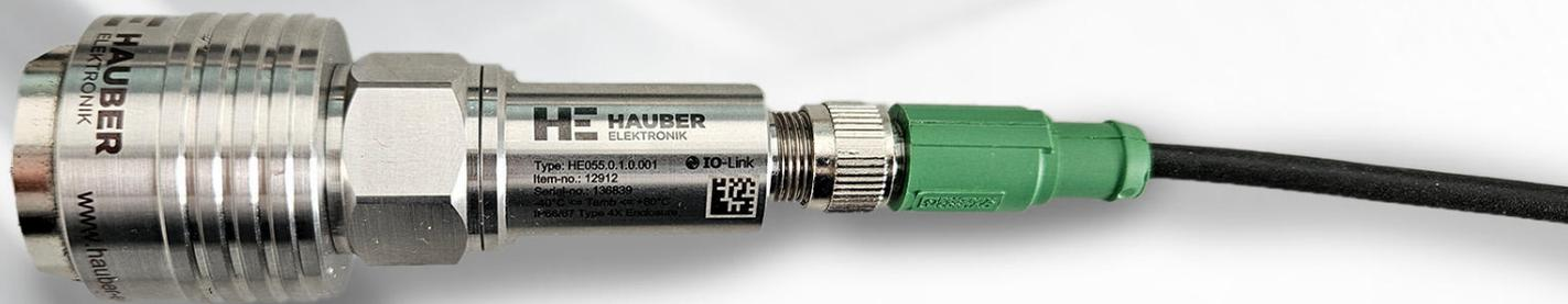
Der neue Magnetadapter **MAP02** von HAUBER-Elektronik bietet eine flexible und präzise Möglichkeit, Sensoren ohne Bohrungen oder Klebestellen zu installieren. Mit einer Haltekraft von 342 Newton (34.2kg) haftet er perfekt auch an gekrümmten Oberflächen. In Kombination mit den Schwingungssensoren ermöglicht der **MAP02** eine präzise Erfassung und Übertragung von Schwingungsdaten.
