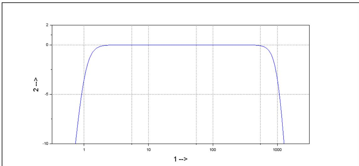
Abb. 3: Typischer Frequenzgang 1 Hz bis 1000 Hz
