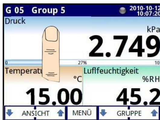
Abb. 6.2 Hauptansicht des Geräts – aktive Navigationsleiste
